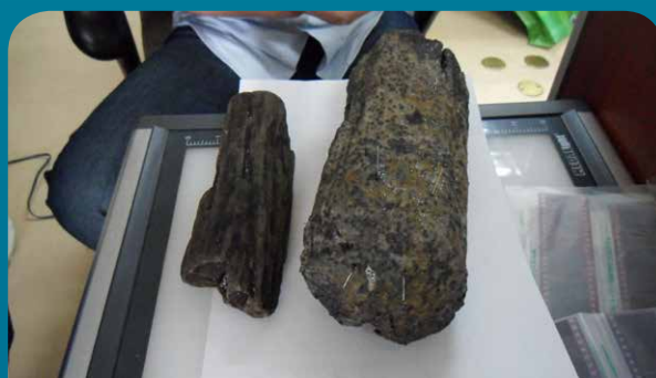
插針測試木材腐朽程度
