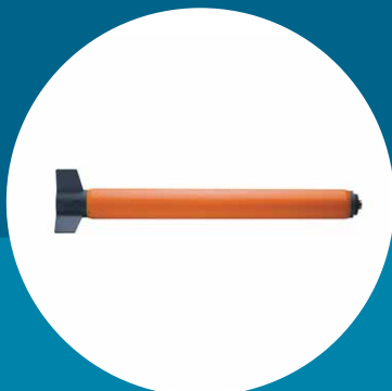
磁力儀 (MAG) 探測用於調查鐵磁性物質及地區性地質結構所造成之磁力異常，以了解周邊是否有目標物
