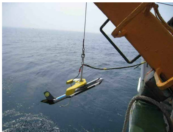
側掃聲納可以掃測海床上的特徵物，量測特徵物的尺寸大小及其高度，亦可判讀海床底質類別
