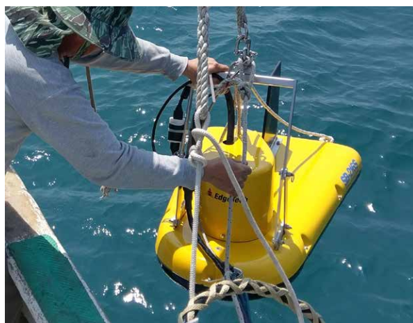
底層剖面儀為低頻聲納 (2-16kHz)，依據海底地質特性不同可以穿透 6-80 公尺，可判斷地層組織及偵測沈埋特徵物，其垂直解析度可達 6-10 公分
