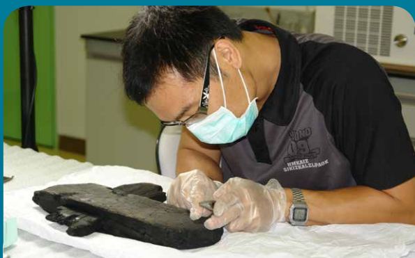
研究員以插針測試飽水木材劣化
